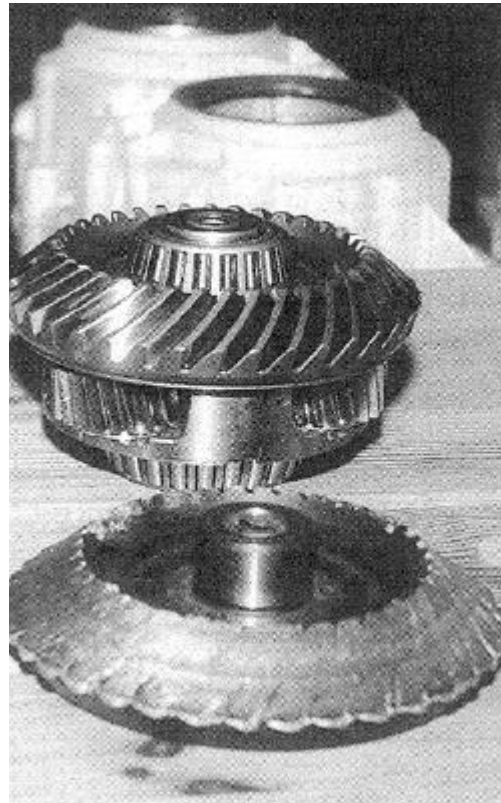
Vorne ein Zahnrad mit abgescherten Zähnen und dahinter ein neues, das in Netstal hergestellt worden ist.
